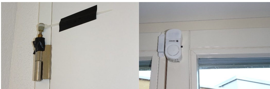
Abbildung 93: Messelement an Türe / Fenster (in Bild noch ohne Kabel zu Logger)
