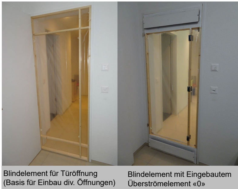
Abbildung 90: Mobiles Blindelement für Türe in Versuchswohnung zur Messung verschiedener Durchlässe
