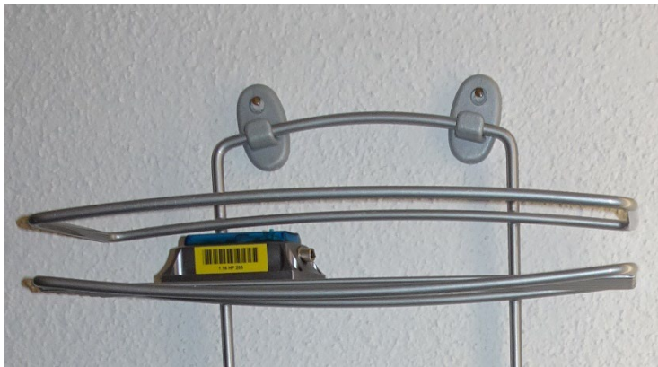
Abbildung 92: Datenlogger für Temperatur und Feuchte und CO2 (Bad)
