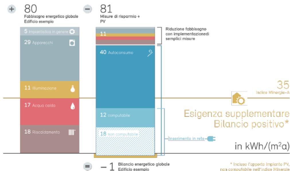
Figura 3: Bilancio energetico e indice Minergie p.es. per una casa plurifamiliare in standard Minergie-A.
