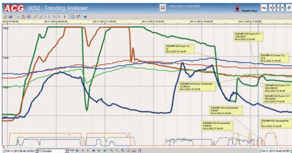
Abbildung 166: CO 2 -Gehalt der Raumluft in 3 Schul- zimmern (ppm). Grün: Bestehendes Zimmer links; blau: Musterzimmer; rot: bestehendes Zim- mer rechts.
