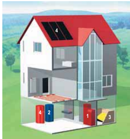
Komponenten Pellets 1 Pelletskessel, 2 Boiler/Wassererwärmer, 3 Pellets-Lager, 4 Solaranlage
