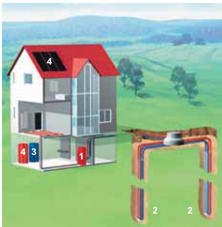
Komponenten Sole/Wasser Wärmepumpe 1 Wärmepumpe, 2 Erdwärmesonden, 3 Boiler/Wassererwärmer, 4 Solaranlage
