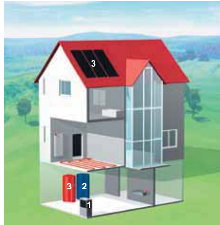
Komponenten Luft/Wasser Wärmepumpe 1 Wärmepumpe, 2 Boiler/Wassererwärmer, 3 Solaranlage
