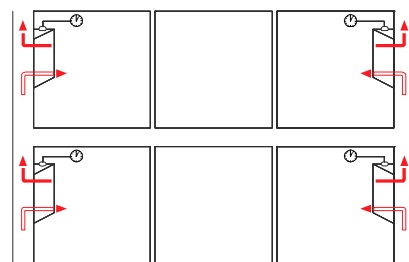
Aération automatique par les fenêtres
