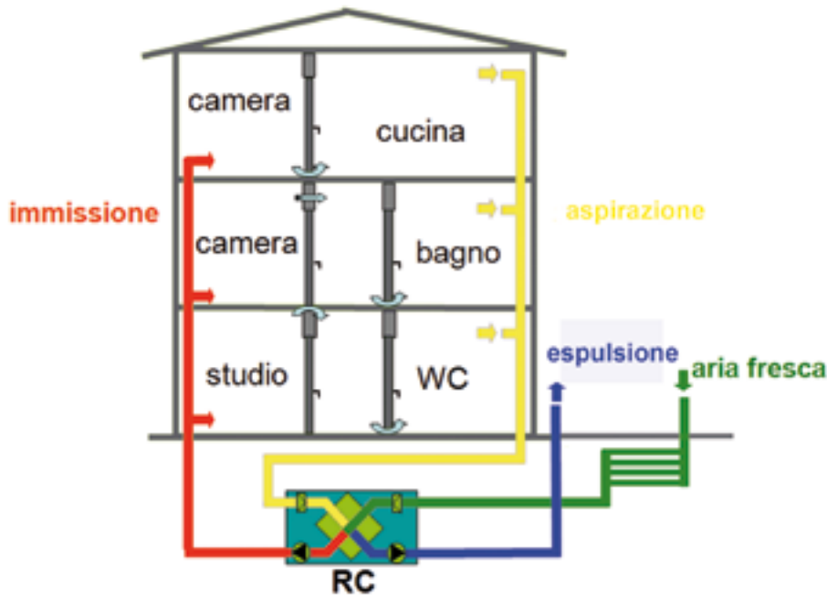
Concetto del sistema di aerazione controllata.
