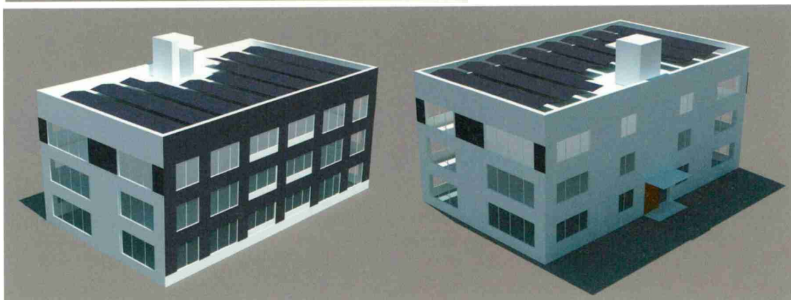
Figur 5: Altes Mehrfamilienhaus gemäss Minergie-Erneuerungs-Standard saniert: Zur Erreichung der Plusenergie-Bilanz müssen zusätzlich Fassadenmodule integriert werden. Ansicht von Südwesten und Nordosten.
