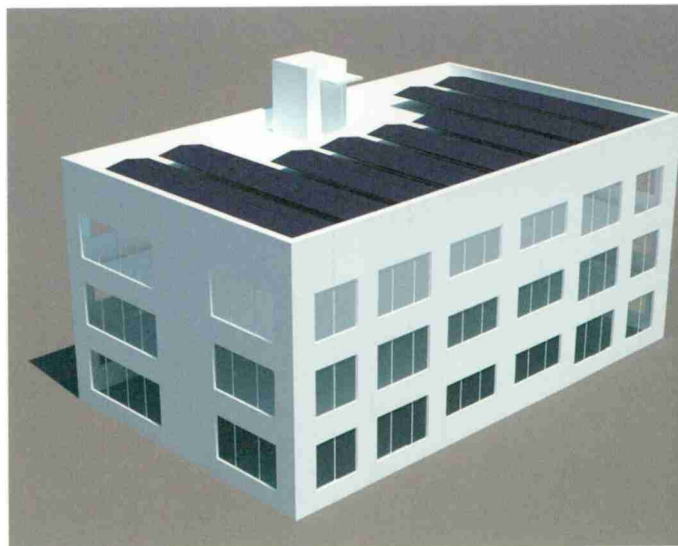
Figur 4: Gebäudeanforderungen gemäss Minergie-Neubau-Standard: mit 132 m 2 Panelfläche auf dem Dach wird der Minergie-A-Standard erreicht. Ansicht von Südwesten.
