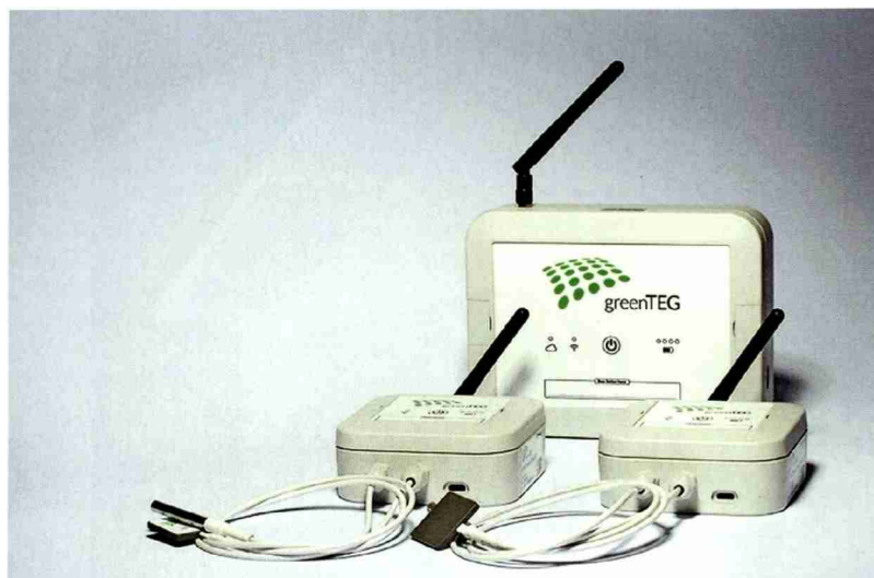
Für die Messungen wurden Geräte verwendet, die durch die Kombination von Wärmefluss- und Temperaturmessungen den U-Wert bestimmen können.
