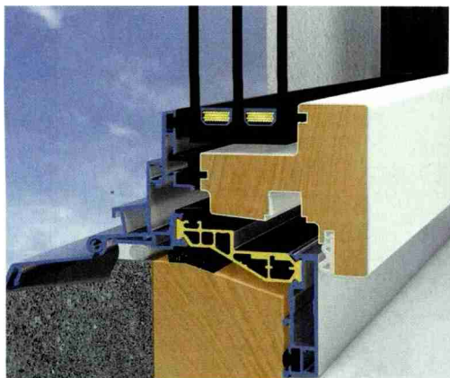
Für Sanierungen wurde das 4B-Wechselrahmensystem entwickelt, bei dem die bestehenden Rahmen zurückgeschnitten werden und als stabile Verankerung für das neue Renovationsfenster dienen. (Bild: 4B)
