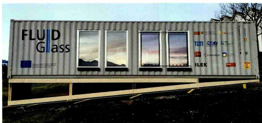
Testcontainer mit Fluidglas. Bei diesem Fenstersystem wird Wasser als flüssiger Speicher eingesetzt; es kann aktiv heizen und kühlen.
