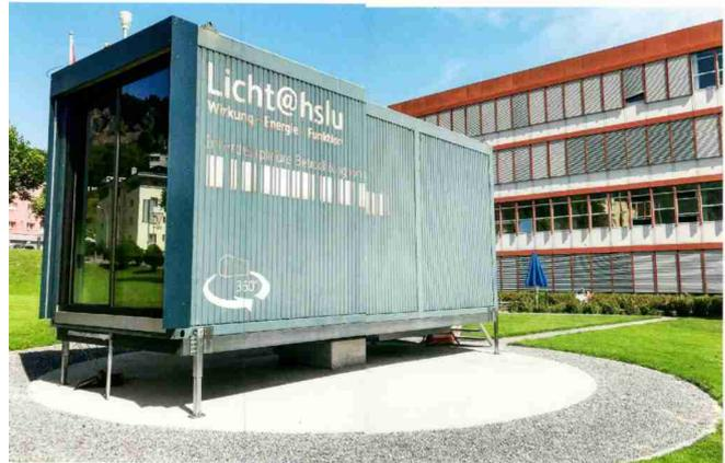
Auf dem Campus Horw unterhält die Plattform «Licht@hslu» einen drehbaren Lichtmesscontainer, in dem unter realen Bedingungen Themen wie zum Beispiel Gebäudeautomation, Tageslicht, Sonnenschutz und Komfort praktisch erforscht werden können.
