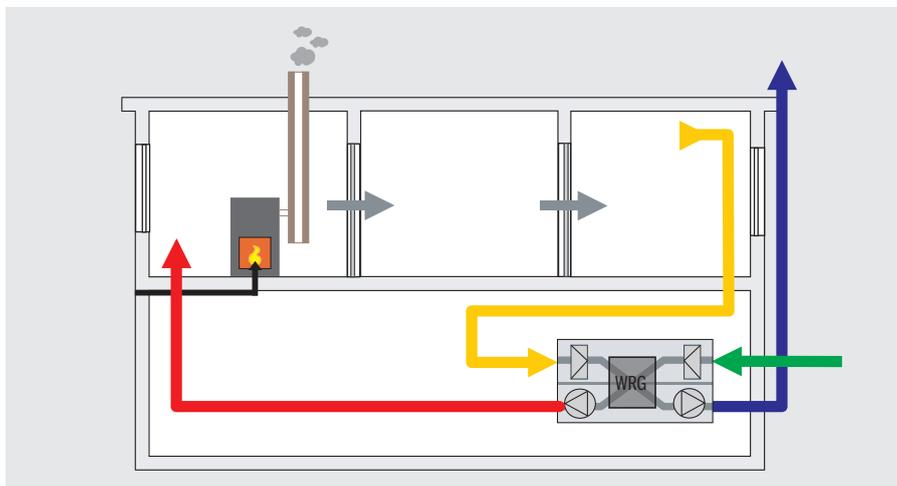
Abbildung 3: Feuerstätte und einfache Abluftanlage – unzulässige Kombination
