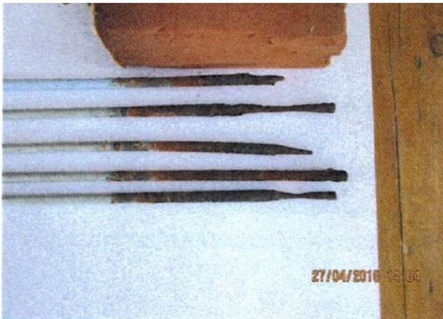
e) Dégâts dus à la corrosion des fixations traversant l'isolation intérieure
