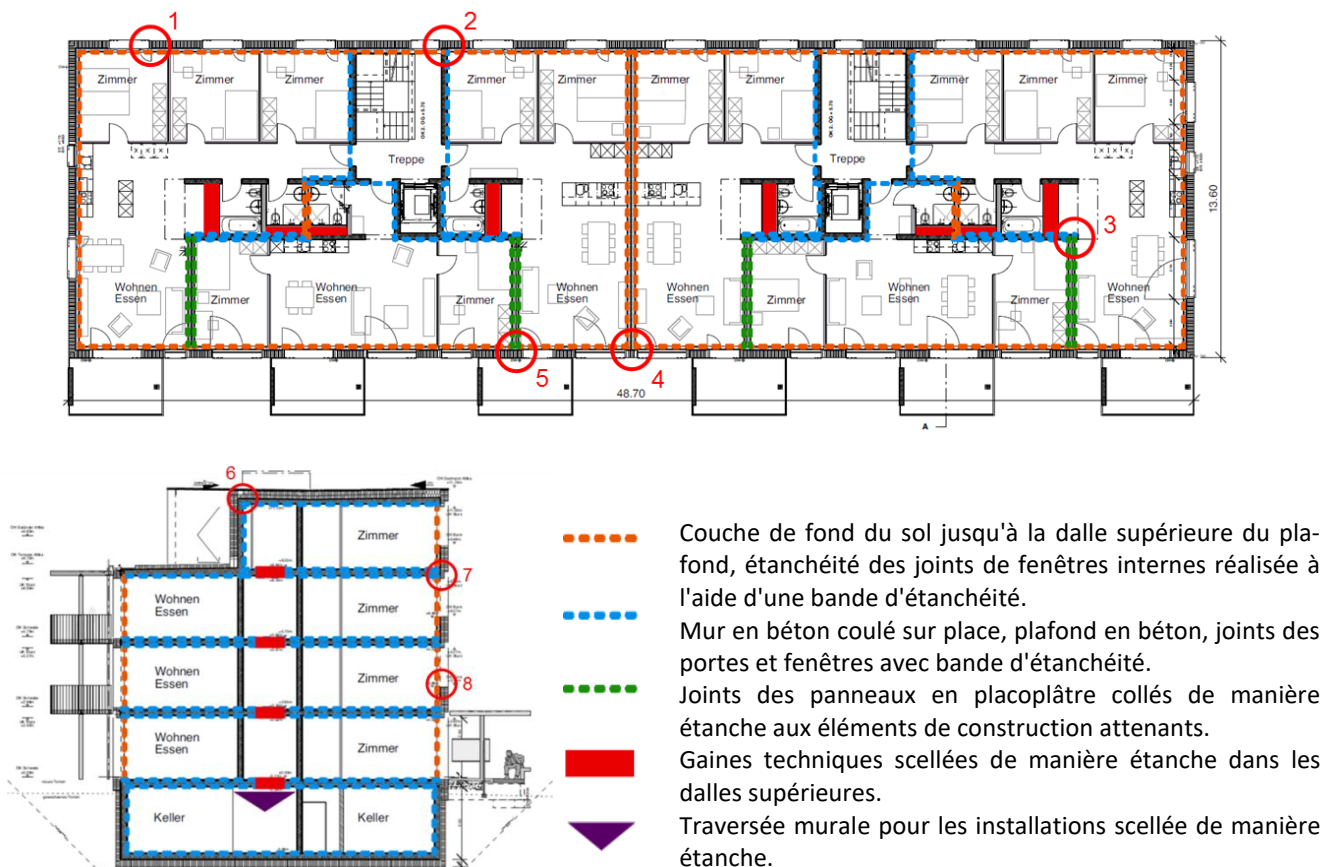
Illustration 4 : En haut : plan avec inscription des mesures relatives à l'étanchéité. En bas à gauche : coupe avec inscription des mesures relatives à l'étanchéité. En bas droite : légende des mesures. Source : demande modèle Minergie-A
