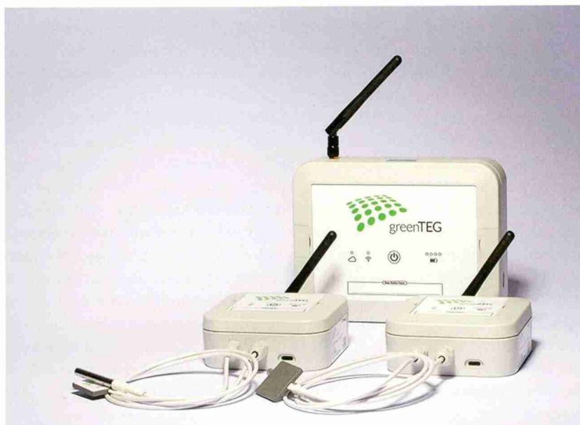
Pour les mesures, on a utilisé des appareils qui peuvent déterminer la valeur U en combinant les mesures du flux thermique et de la température.
