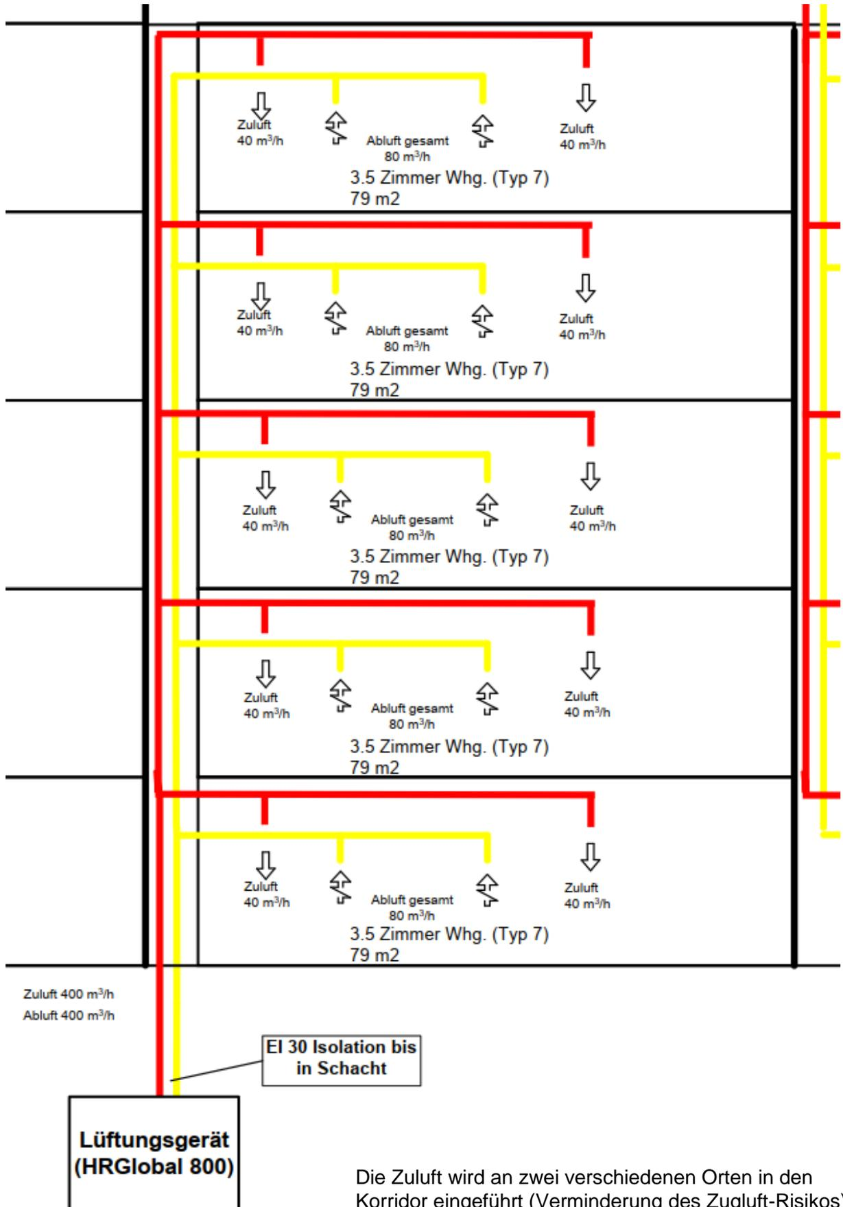
Die Zuluft wird an zwei verschiedenen Orten in den Korridor eingeführt (Verminderung des Zugluft-Risikos), die Abluft in der Küche und im Bad abgeführt.
