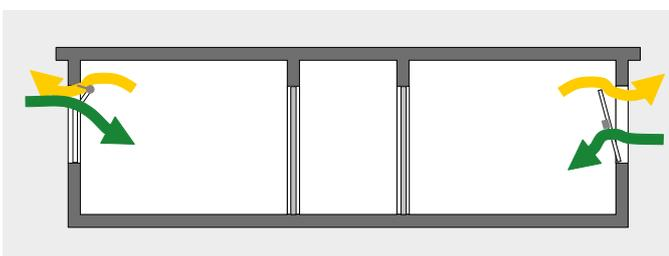
In Küche, Bad/Dusche und WC werden Feuchte und Gerüche automatisch abgeführt, und die Abluftvolumenströme entsprechen dem SIA-Merkblatt 2023. Dazu kommen einfache Abluftanlagen in Frage. Die Nachströmung von Ersatzluft erfolgt dabei über Aussenluft-Durchlässe oder Fenster mit automatischen Antrieben. In beiden Fällen sind die Anforderungen analog der Kriterien für reine Abluftanlagen einzuhalten (siehe Kasten «Anforderungen an die Abluftanlage»).
