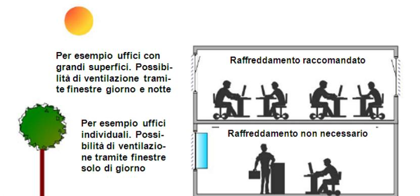
Figura 13 carichi termici interni e aerazione tramite finestre.
