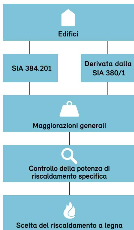
Procedimento per il dimensionamento di un riscaldamento a legna decentrale. Fonte: SvizzeraEnergia
