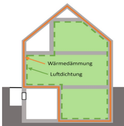
Figura 14: Nel caso di abitazioni MF più datati, è necessario stabilire dove si sviluppa il perimetro ermetico
