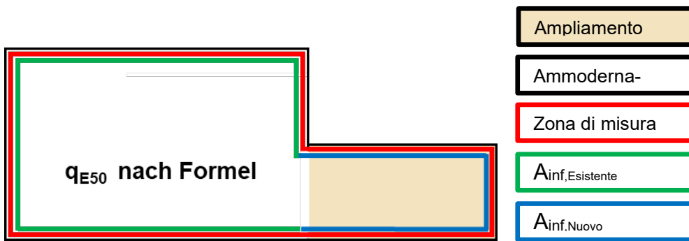
Figura 19: Misura "mista" per ammodernamento e ampliamento come schizzo del sistema. P. es. costruzione annessa aperta (p. es. abitazione MF con ampliamento dello spazio abitativo)
