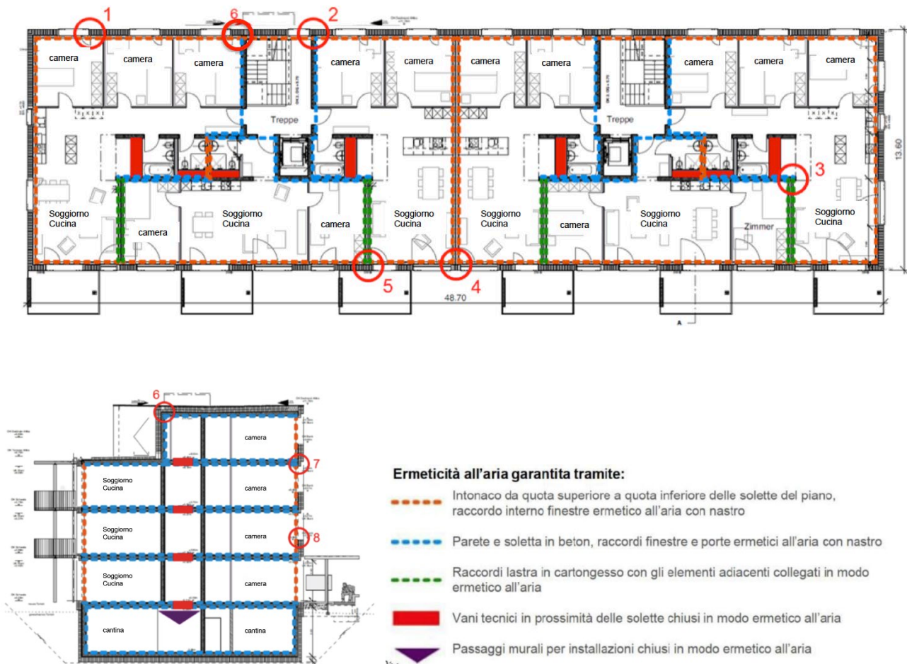
Figura 5: sopra: pianta con indicati i provvedimenti per l'ermeticità all'aria. In basso a sinistra: sezione con indicati i provvedimenti per l'ermeticità all'aria. In basso a destra: legenda dei provvedimenti. Fonte: esempio di dossier per domanda di certificazione Minergie-A
