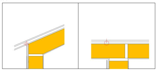
Ces ponts thermiques peuvent généralement être négligés si le niveau d'isolation thermique est réalisé sans faille.
