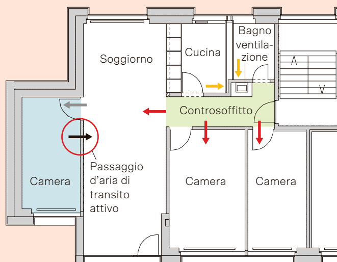
Figura 3.9: Tre locali ricevono l'aria immessa attraverso un classico sistema di distribuzione dell'aria. Una camera è dotata di un sistema di ventilazione di collegamento con il soggiorno.
