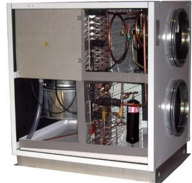
Lüftungsgerät mit Abluft/Zuluft-WP, ohne WRG (Bildquelle: Nilan AG)
