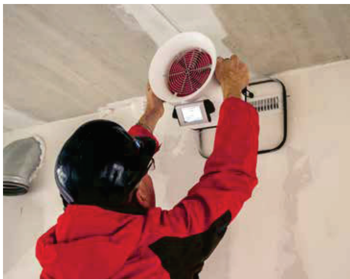
Bild 12.1: Volumestrommessgerät mit Nulldruckkompensation. (Quelle: ACIN instrumenten bv, BG Rijswijk NL)
